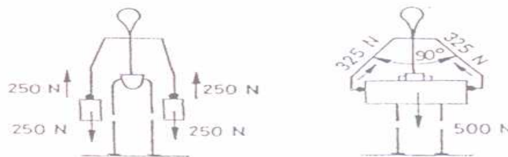
a) b) 3.7 ábra A teher egyenletes elosztása (l. a) jelű ábra) kisebb terhelést eredményez
